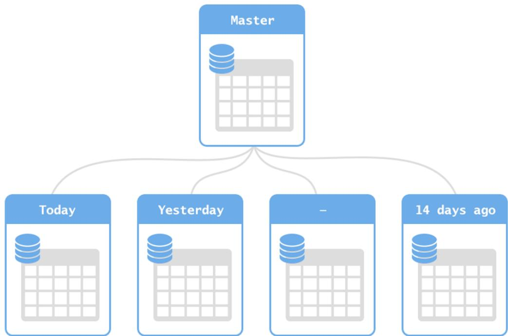
Рисунок 2.3 – Схема секционирования таблицы базы данных [сделано автором]
