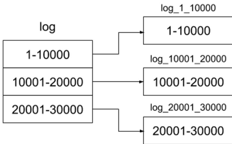
Рисунок 2.4 – Секционирование (вертикальный шардинг) применимо к таблице log [сделано автором]
