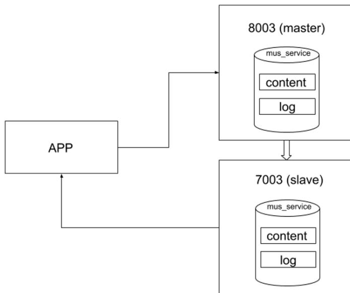
Рисунок 2.2 – Схема ИС с настроенной репликацией master-slave
