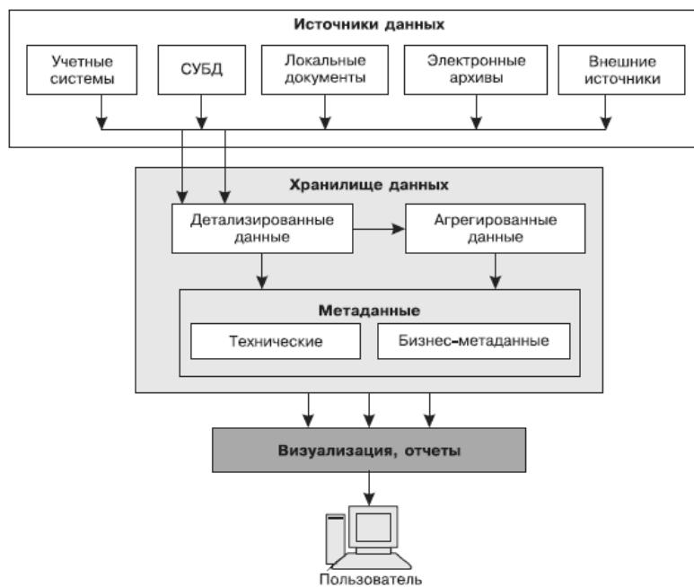
Рисунок 1.4 – Типовая конфигурация хранилища данных [4]
