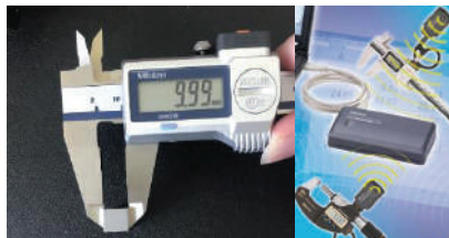
Рисунок 2. Измерение детали на ШЦЦ - 150 с радиоканалом и топология аналоговных инструментов (справа)
