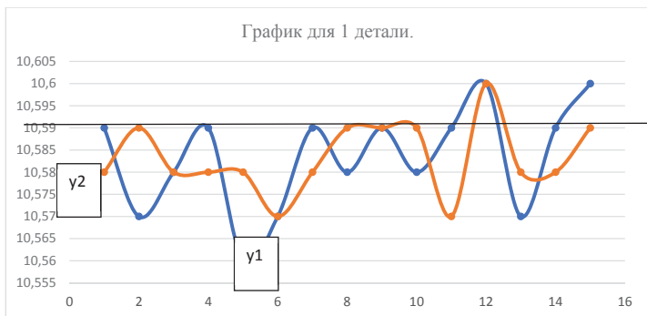
Рисунок 3 - График y_1 - измерения без использования кнопки, график y_2 - с использованием кнопки. Черная линия – эталон
