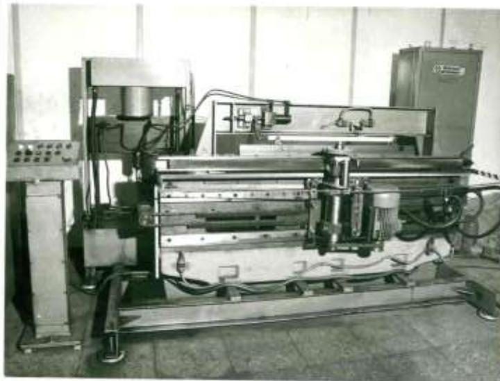
**Рисунок 2 - Опытная конструкция фрезерного суппорта**
