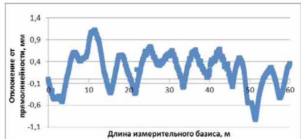
Рисунок 3 – Результаты отклонения от прямолинейности по вертикали (ось Y) полученные с помощью Fixturlaser
