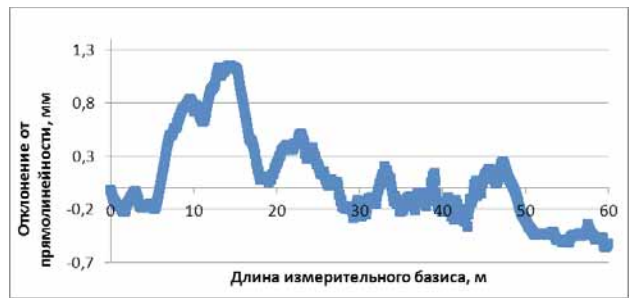
Рисунок 2 – Результаты отклонения от прямолинейности по горизонтали (ось X) полученные с помощью Fixturlaser
